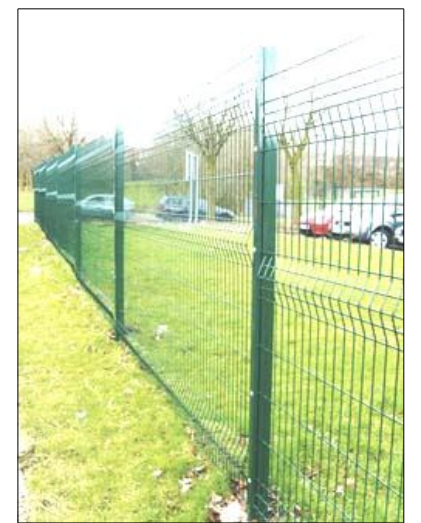
PANEĻVEIDA ŽOGS NO KARSTI CINKOTA STIEPLES, PĀRKLĀTS AR PAPILDUS AIZSARGĀJOŠU, IZTURĪGU PVC SLĀNI. ACS IZMĒRS 200 X 50 mm UN 100 X 50 mm STIENŅU POSMOS, ŽOGA AUGSTUMS ≥ 1.50 m. STIEPLES DIAMETRS AR PVC ≥ 5.0 mm. BALSTI KARSTI CINKOTI NO IEKŠPUSES UN NO ĀRPUSES, PĀRKLĀTI AR POLIESTERA SLĀNI, PĀRKLĀJUMA BIEZUMS min 60 MIKRONI. KRĀSA ŽOGAM - ZAĻĀ. ( http://betafence-zogi.lv Nylofor® 3D VAI ANALOGS).
